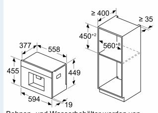
Bohnen- und Wasserbehälter werden von vorne entfernt Empfohlene Installationshöhe 950–1450 mm
