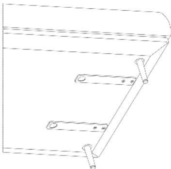
Aus transporttechnischen Gründen werden die Laschen nach innen geschwenkt geliefert. Lösen Sie daher vor dem Koppeln die Befestigungsschrauben und montieren die Lasche um 180° nach außen gedreht.
