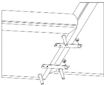
Die Anreihelemente werden durch Einhängen der Kunststoff-Kegel in die Metall-Laschen aneinandergesekelt.
