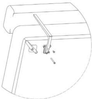
Insgesamt müssen pro Rücken oder Seitenteil immer 6 Schrauben gelöst werden. Bitte die gelösten Schrauben gut aufbewahren. Die Rücken und Seitenteile auf eine entsprechend sauber Unterlage ablegen. Bitte merken Sie sich welche Teile an welcher Position montiert waren, um diese anschließend, auch wieder an der gleichen Position montieren zu können.
